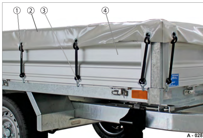
Abb. 43 Beispiel: Flachplane bei Grundbordwand
