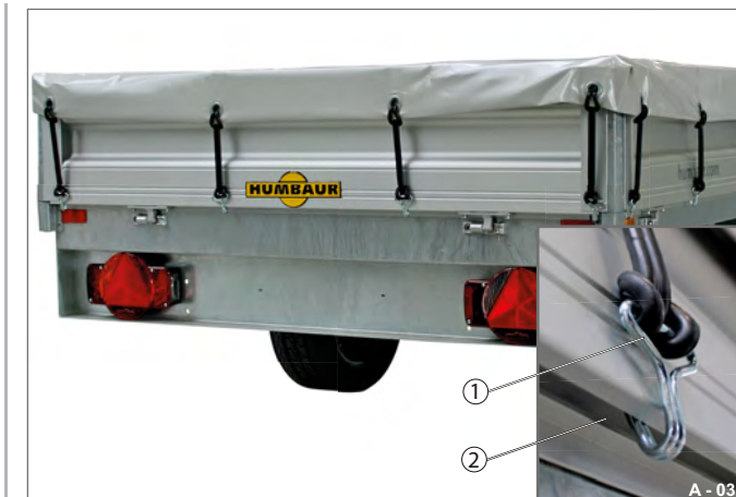
Abb. 51 Flachplane gesichert (bei Grundbordwand)
